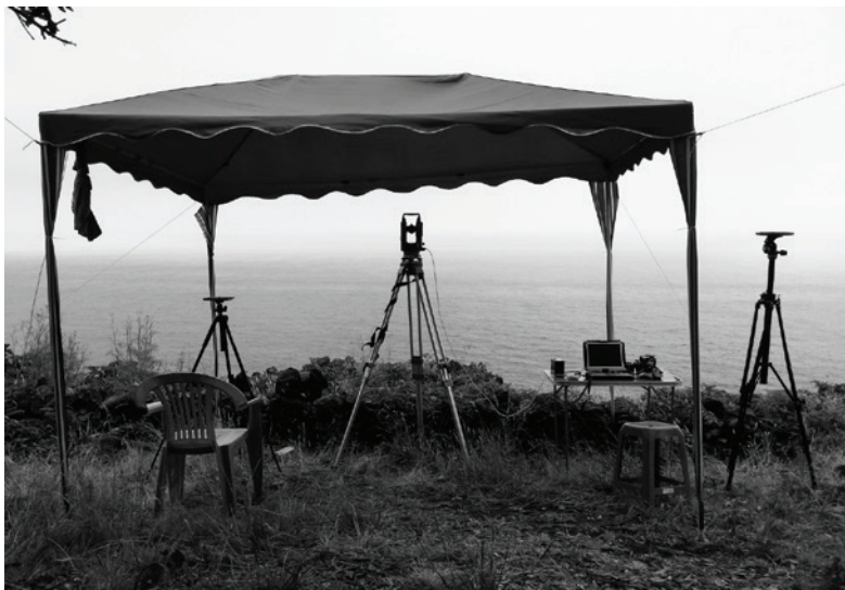
Estação Terrestre. Ao centro um teodolito digital, ligado ao computador (em baixo, do lado direito).
